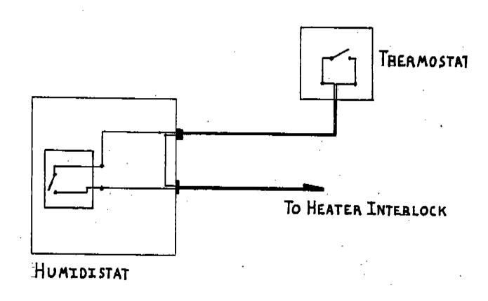
BOTH HUMIDISTAT AND THERMOSTAT MUST BE CLOSED FOR HEATER OPERATION
