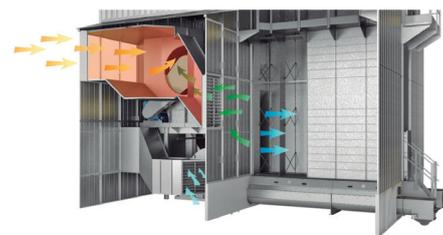
O ventilador superior (maior) é responsável pela condução do ar quente que vem dos ciclones para a câmara de secagem. O ar da câmara de enclausuramento pode ser reaproveitado pelo ventilador, gerando um ganho de até 30% na eficiência energética. Os dutos dos dois ventiladores são interligados à fornalha, sendo que o ventilador inferior (menor) pode trabalhar com ar de resfriamento ou ar quente, quando se deseja coluna inteira de secagem.
