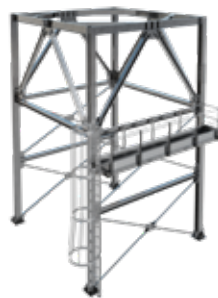
Estructura de escalera marinera
