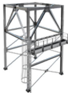
Estructura de escalera marinera
