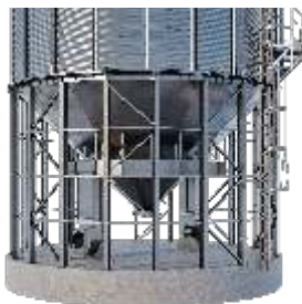
Aeração silo fundo cônico - vista externa
